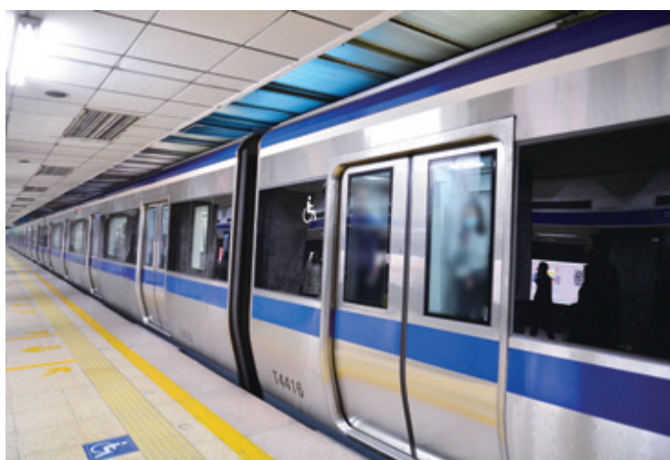
图3-15 用不锈钢制造的地铁列车的车体
