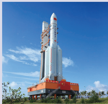
图2-2-8 使用氢燃料的长征5号运载火箭
