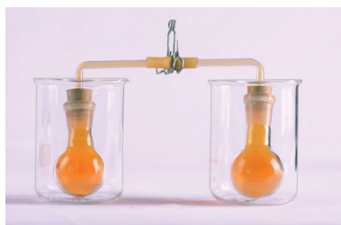
图2-3-8 装有 \text{NO}_2 和 \text{N}_2\text{O}_4 混合气体的装置两端的球形容器分别浸入冷水和热水中
