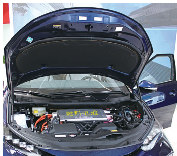
图2-2-14 用于驱动汽车的燃料电池
