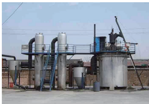
图3-2-3 工业燃煤气化炉
