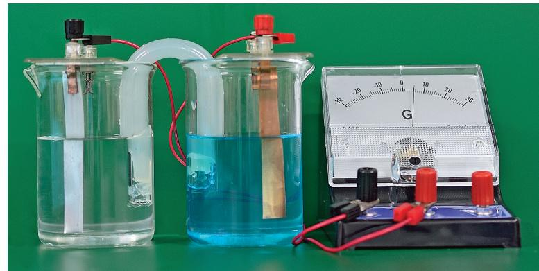
图 4.2 铜锌原电池的实验装置图
