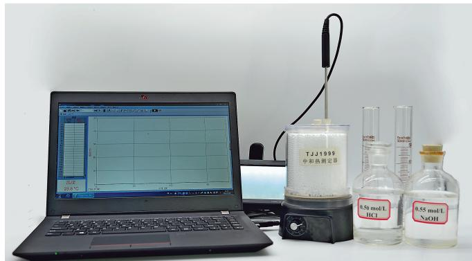
图 1.4 测定中和反应反应热的实验装置
