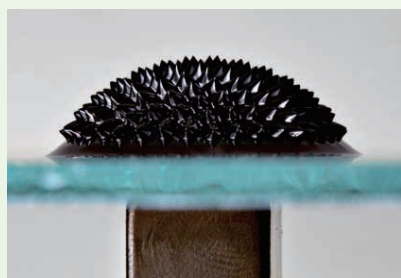
图 3-3-6 在磁场作用下的磁流体表现出与铁粉在磁场中类似的形态特征
