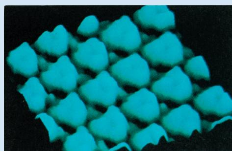
扫描隧道显微镜观察到的苯分子
