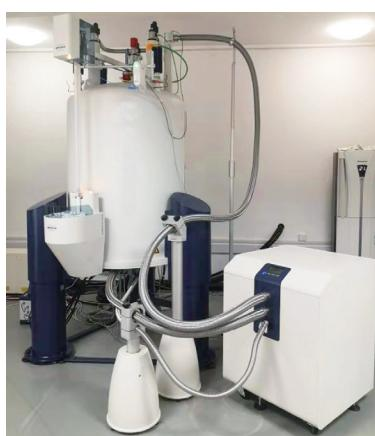
图 1-13 核磁共振仪
