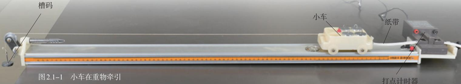
图 2.1-1 小车在重物牵引下沿木板运动的实验装置
