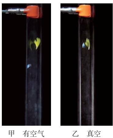
图2.4-1 玻璃管内的羽毛、铁片的下落
