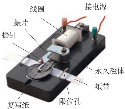
图 1.2-7 电磁打点计时器
