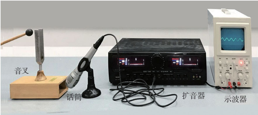
图 2-1-5 用示波器研究声振动
