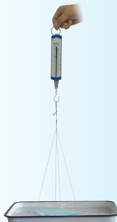
图1-6 玻璃板与水之间的分子引力实验
