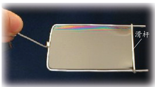
图 2-14 U 形铁丝框肥皂膜实验现象
