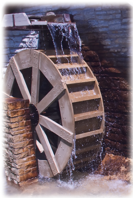
水车被高处落下的水冲击而转动
