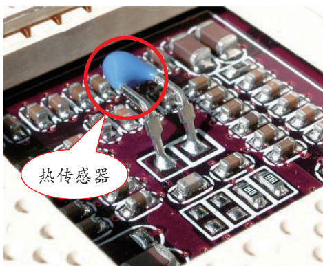
图5-4 计算机内部的热传感器
