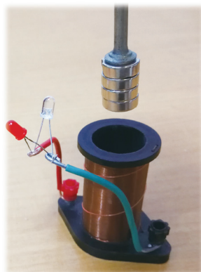
图 2-9 观察发光二极管亮度的变化
