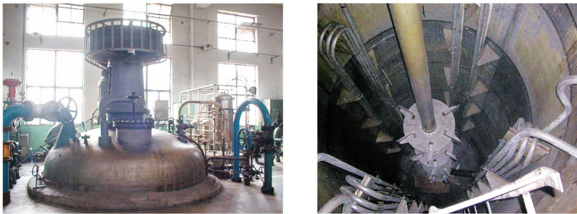
图 1-24 发酵罐（左）及其内部结构（右）
